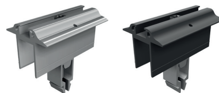
Pinzas intermedias Vario con clavija de puesta a tierra para una altura del marco de 30 mm - 50 mm
