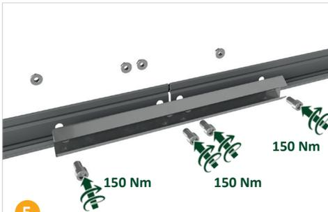
5. Coloque el conector de correas en el lado de la correa que no está cableado y atornille con las fijaciones suministradas (ver figura 5)
