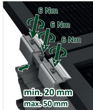
8. Encaje la pinza final, coloque el primer módulo encima y alinéelo según las dimensiones del plano de la mesa.
